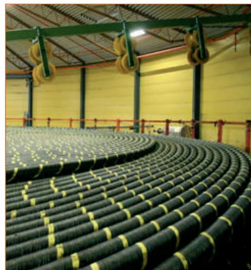
Plataforma de almacenamiento de cable submarino, en una sola pieza.
