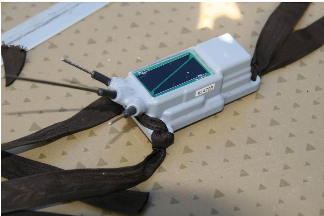
**Fotografía 5.- Emisor GPS/GSM datalogger de 48 g de peso de la marca alemana E-obs Telemetry utilizado para el seguimiento de águila perdicera en el PN de la Sierra de Espadán (Castellón).**
