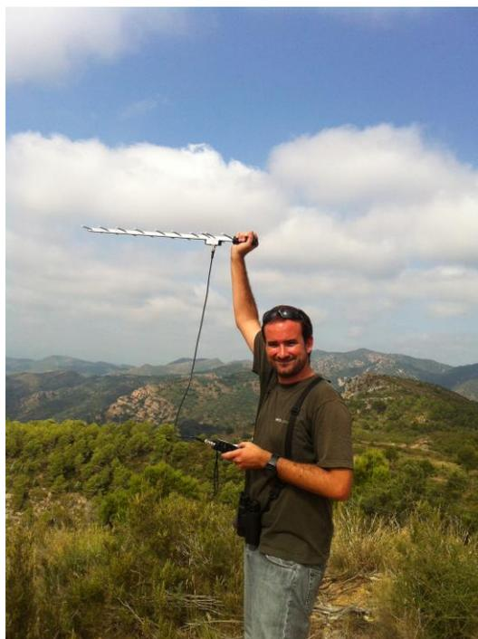
**Fotografía 6.-** Descarga de datos directamente en el campo a través de la estación base receptora conectada a la antena Yagi direccional (izquierda). Localización de las águilas en el campo mediante radio-tracking VHF convencional previa a la descarga de los datos (derecha).
