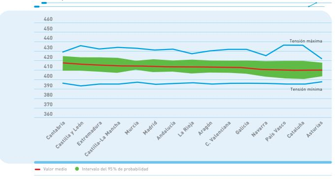
Valores de las tensiones límites con una probabilidad del 95 % para la red de 220 kV  $_{(kV)}$
