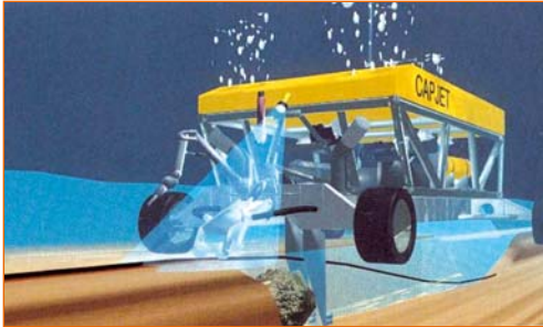
Simulation du processus d'enterrement des câbles dans le fond marin
