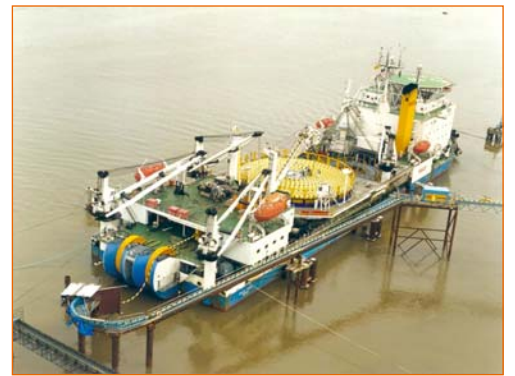
Bateau utilisé pour la pose du câble sous-marin
