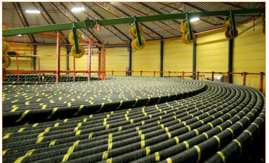
Plate-forme de stockage de 30 km de câble sous-marin, d'une seule pièce, préparé pour la pose
