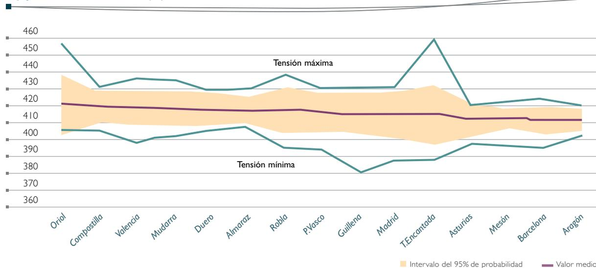
**Valores de las tensiones límites con una probabilidad del 95% por zonas y para la red de 220 kV (kV)**
