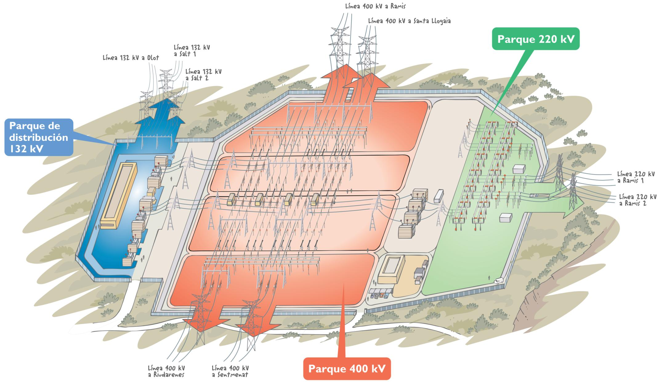
La subestación de Bescanó se compone de tres parques (nudos de unión de las diferentes redes de transporte y distribución): dos parques de transporte, de 400 y 220 kV, y otro de distribución, de 132 kV.
