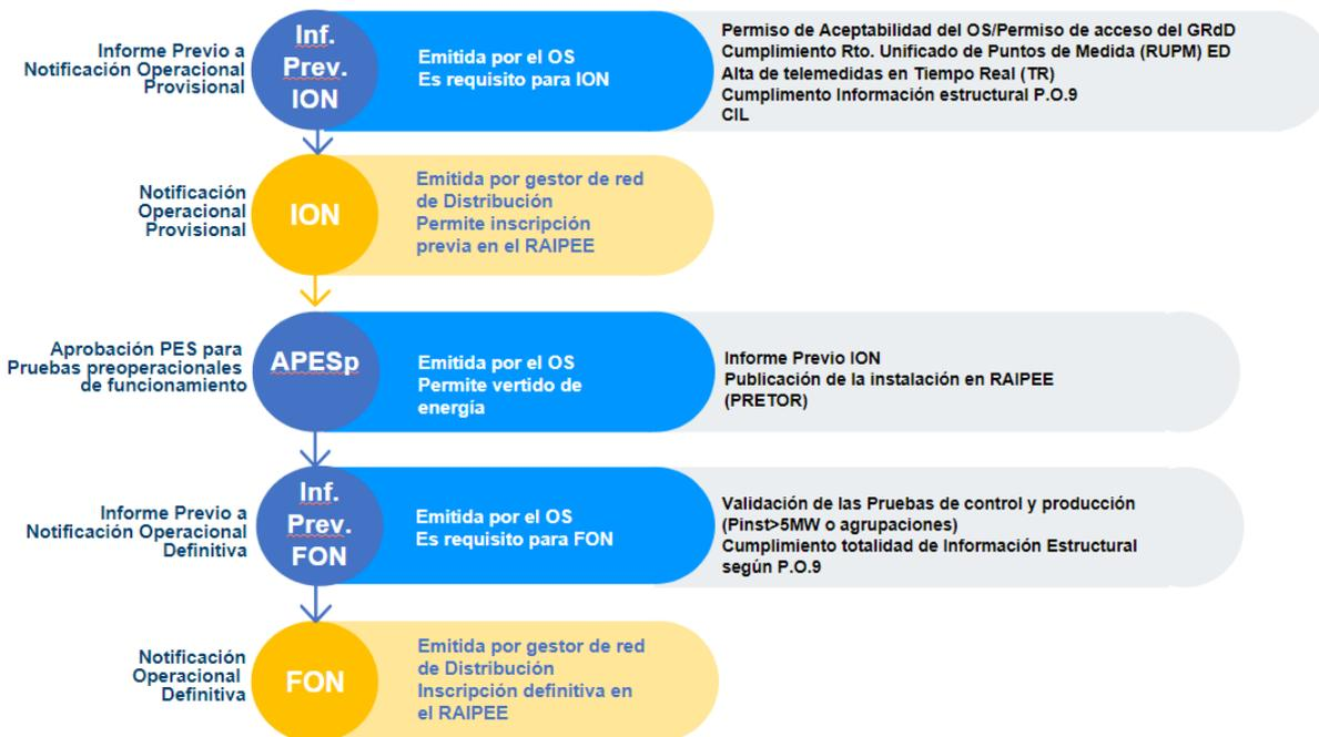
Figura 2. Notificaciones operacionales aplicables a MGE conectados a RdD, con una potencia instalada > 1 MW SEPE / 0,5 MW TNP
