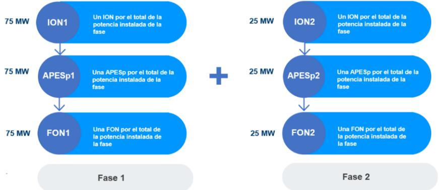
Figura 10. PES en dos fases (75MW y 25 MW) con APESp total en ambos casos.
