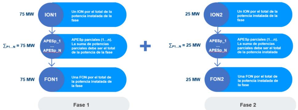
Figura 9. PES en dos fases (75MW y 25 MW) con APESp parciales en ambos casos
