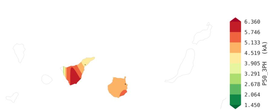
Figura 9. Mapa de curvas de nivel con la distribución de los valores percentil 50 de intensidad de cortocircuito trifásico en los nudos de 220 kV.
