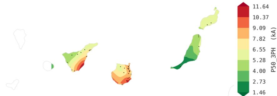
Figura 10. Mapa de curvas de nivel con la distribución de los valores percentil 50 de intensidad de cortocircuito trifásico en los nudos de 66 kV.
