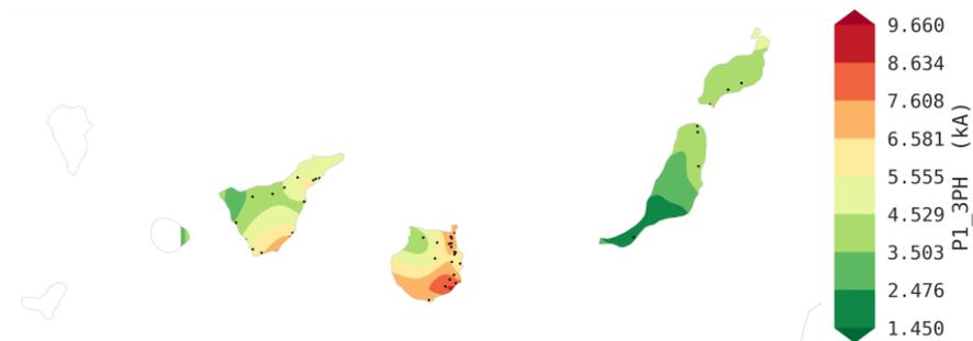
Figura 15. Mapa de curvas de nivel con la distribución de los valores mínimos de intensidad de cortocircuito trifásico en los nudos de 66 kV.
