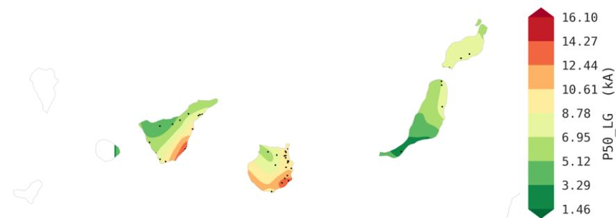
Figura 25. Mapa de curvas de nivel con la distribución de los valores percentil 50 de intensidad de cortocircuito monofásico en los nudos de 66 kV
