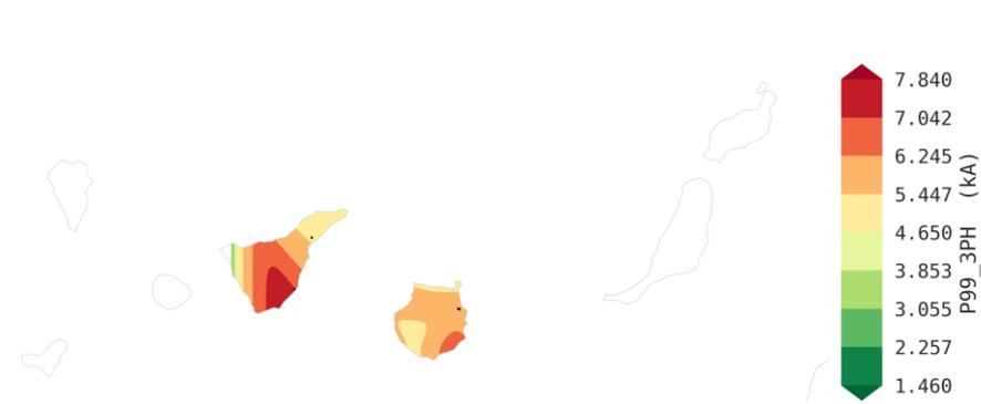
Figura 4. Mapa de curvas de nivel con la distribución de los valores máximos de intensidad de cortocircuito trifásico en los nudos de 220 kV.
