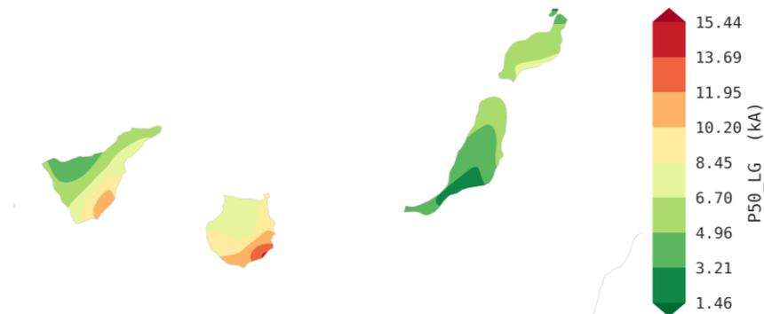
Figura 25. Mapa de curvas de nivel con la distribución de los valores percentil 50 de intensidad de cortocircuito monofásico en los nudos de 66 kV
