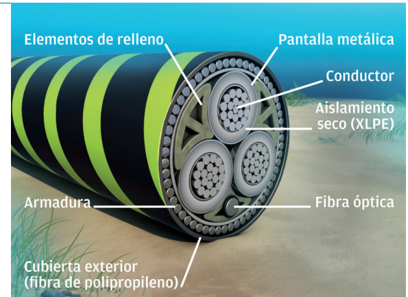
Sección del cable de la interconexión Mallorca-Ibiza
