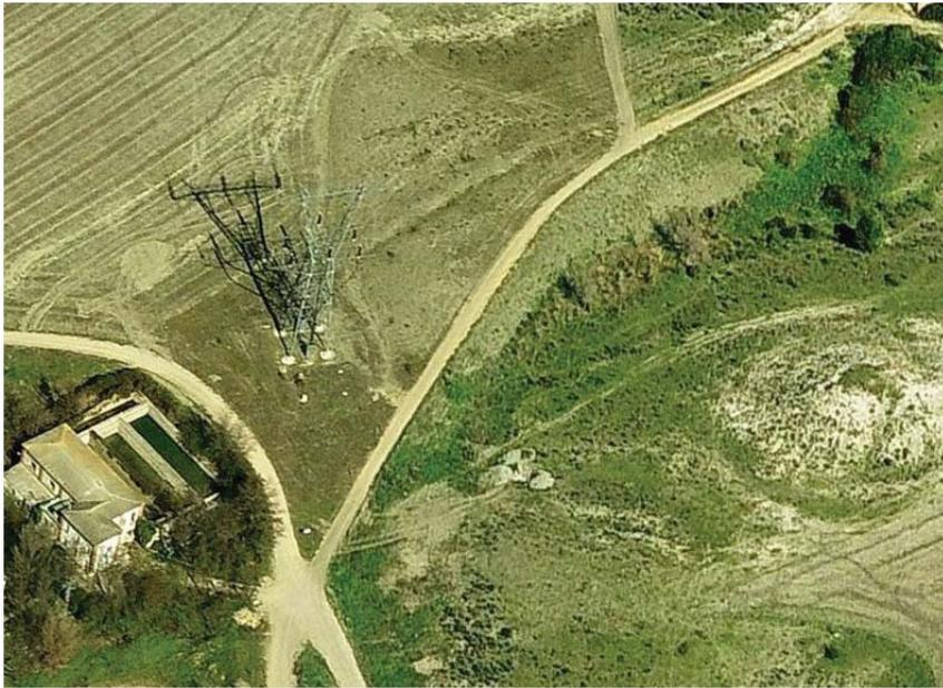
Fotografía 1.-Modelo digital en 3D. Se observa la localización del apoyo, el último tramo del vial en buen estado y el acceso a campo a través.
