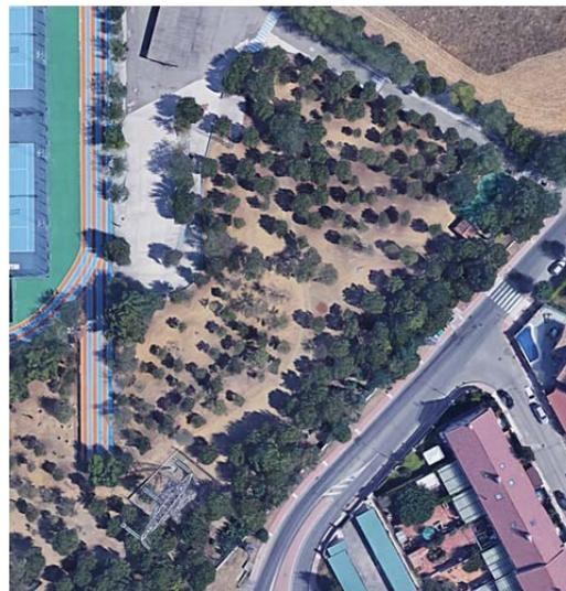
Fotografía 2.- Modelo digital 3D. Se observa el acceso campo a través al Apoyo T-30. La densidad de árboles permite realizar el acceso sin ejecutar talas.
