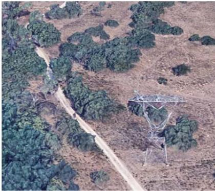
Fotografía 1.- Modelo Digital 3D de la zona en la que se implanta el apoyo T-14. Se observa como las copas de encinas limítrofes al acceso invaden el vial.
