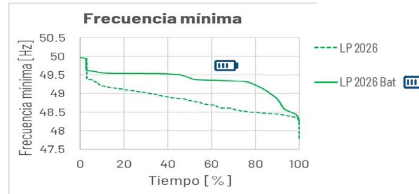
Comparando el escenario H2026, sin almacenamiento, y el H2030 con bombeo + baterías, se observa una notable mejor respuesta potencia-frecuencia del sistema con almacenamiento, a pesar de ser un escenario con más penetración de renovables.
