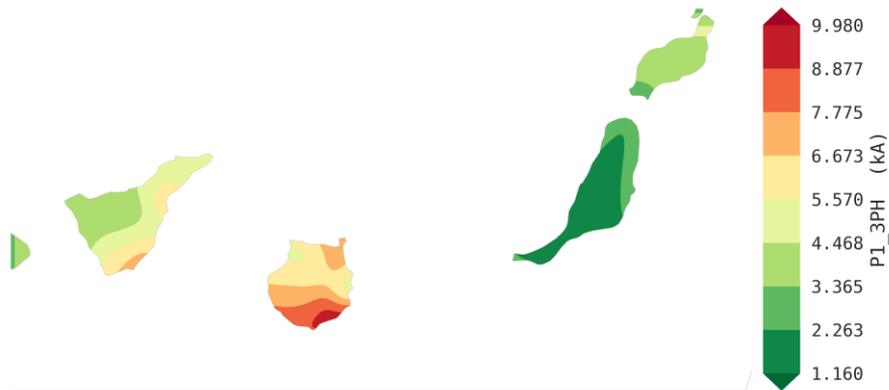
Figura 15. Mapa de curvas de nivel con la distribución de los valores mínimos de intensidad de cortocircuito trifásico en los nudos de 66 kV.
