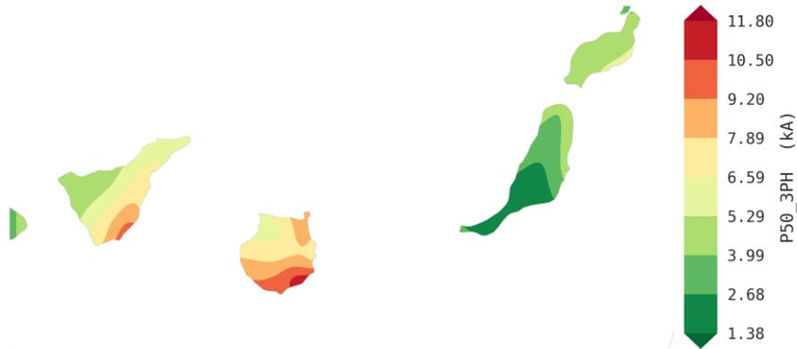
Figura 10. Mapa de curvas de nivel con la distribución de los valores percentil 50 de intensidad de cortocircuito trifásico en los nudos de 66 kV.
