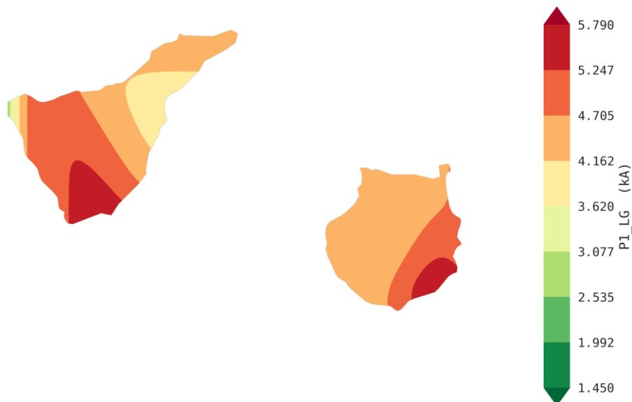
Figura 29. Mapa de curvas de nivel con la distribución del percentil 1 de la corriente de cortocircuito monofásico en los nudos de 220 kV.
