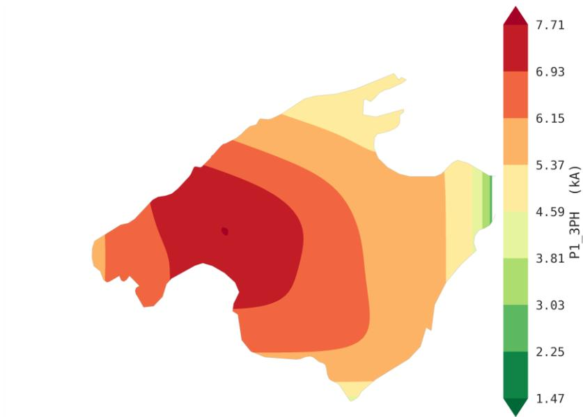
Figura 14. Mapa de curvas de nivel con la distribución de los valores mínimos de intensidad de cortocircuito trifásico en los nudos de 220 kV.
