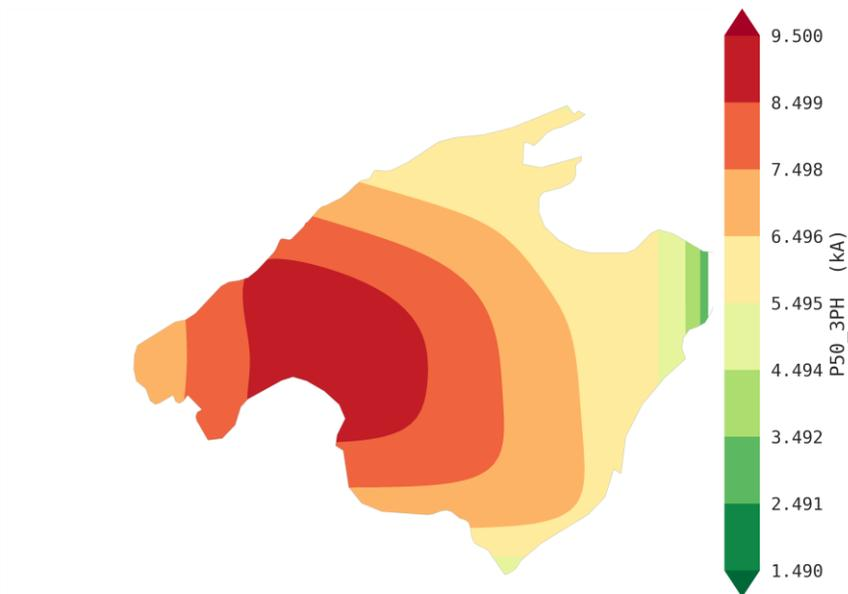
Figura 9. Mapa de curvas de nivel con la distribución de los valores medios de intensidad de cortocircuito trifásico en los nudos de 220 kV.
