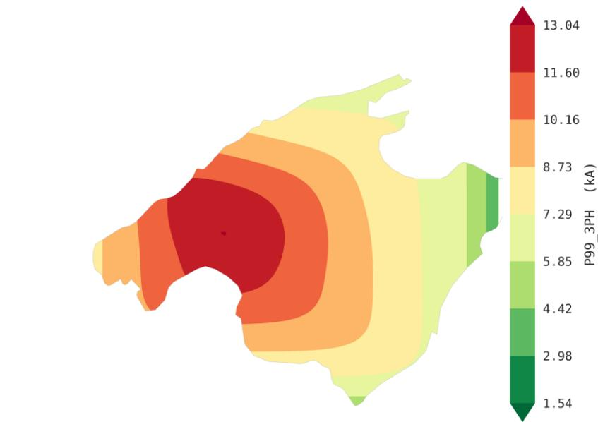
Figura 4. Mapa de curvas de nivel con la distribución de los valores máximos de intensidad de cortocircuito trifásico en los nudos de 220 kV.
