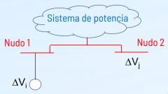
o Índice Ponderado de Potencia de Cortocircuito (WSCR, Weighted Short Circuit Ratio): Relación ponderada entre la potencia de cortocircuito y las capacidades máximas de acceso de MPE en nudos de una misma ZIE, según la siguiente expresión:
