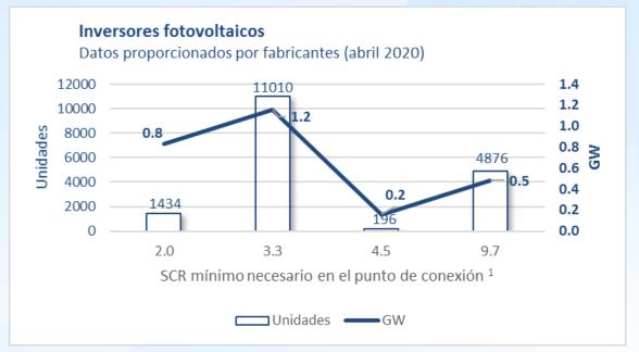
Nota: valores de SCR estimados en el punto de conexión del parque con el sistema eléctrico
