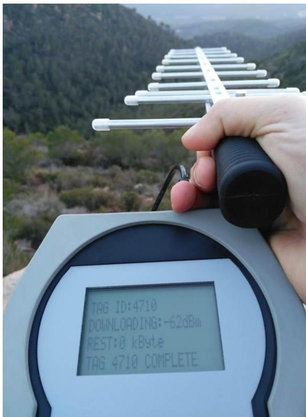
**Fotografía 4.- Descarga directa de datos en el campo a través de la estación base receptora conectada a antena Yagi direccional.**
