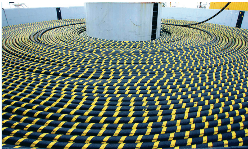
Plataforma de almacenamiento de 30 km de cable submarino, en una sola pieza, preparado para el tendido
