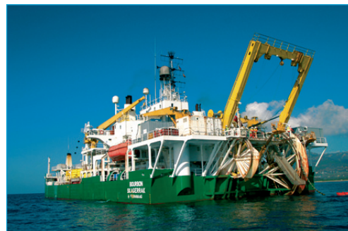
Barco empleado para el tendido del cable submarino
