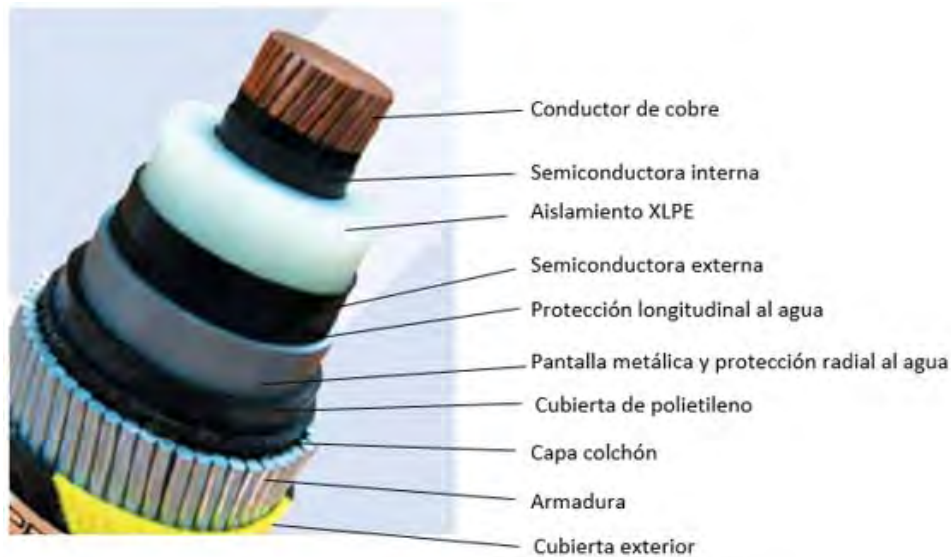
Figura 7. - Sección del cable submarino propuesto
