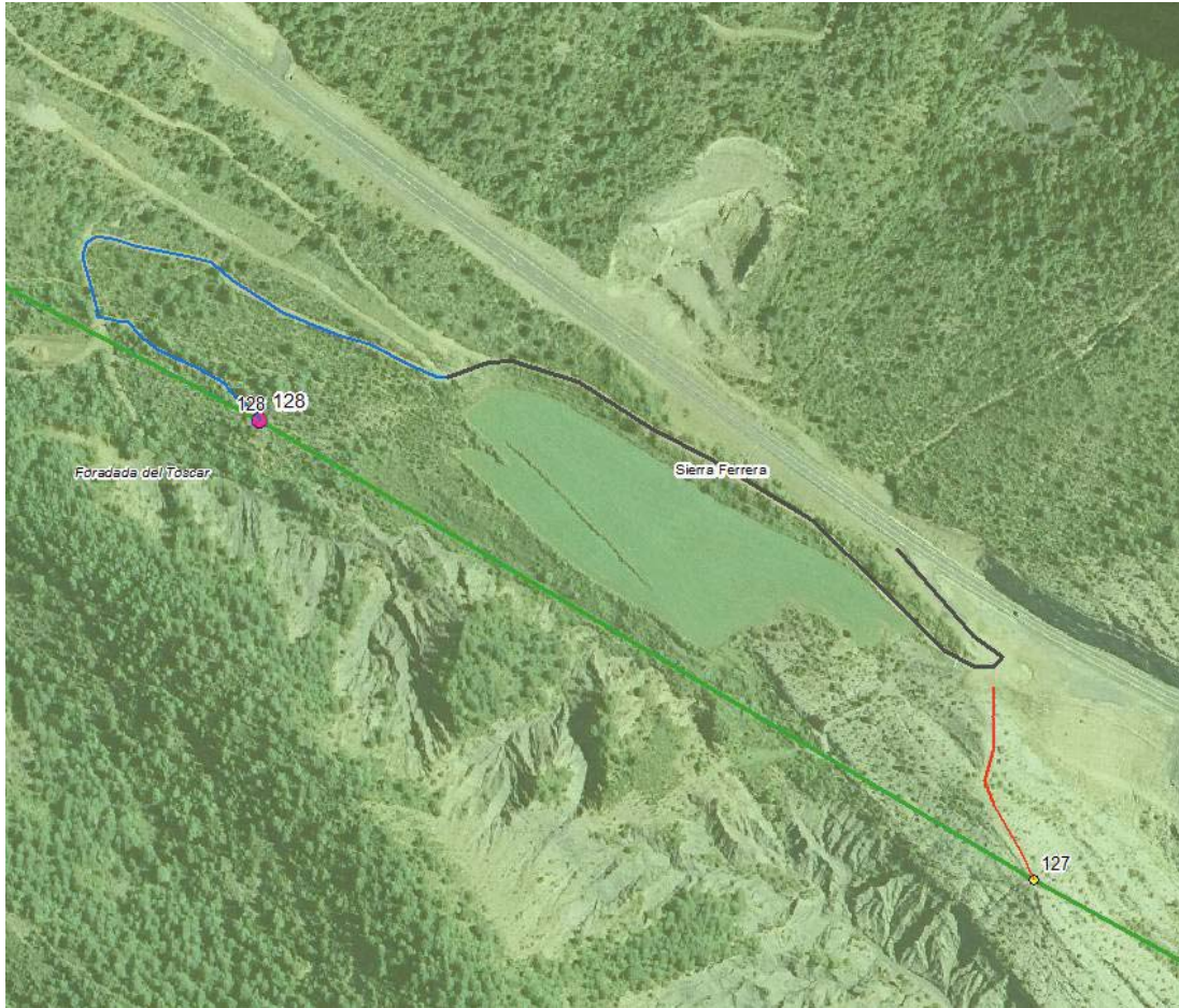
Figura 24. Accesos a ambas alternativas: El apoyo 127 requeriría nuevo acceso de 115 m de longitud, en un terreno muy pedregoso, y con muy poco espacio para ubicar la grúa. Requeriría gran movimiento de tierras. En cambio el acceso al 128 se lleva a cabo por camino existente hasta su base, en la que existe espacio disponible para ubicar la grúa, minimizando el movimiento de tierras.
