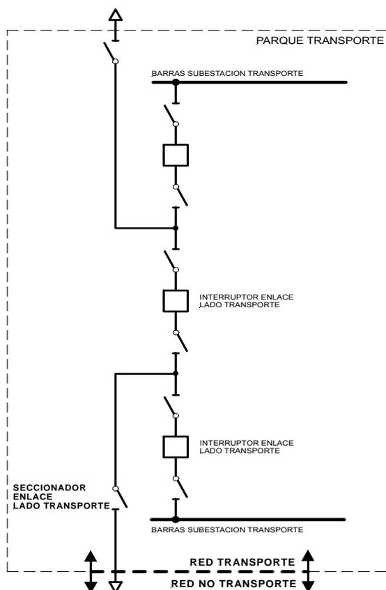
Independientemente de la solución adoptada para la definición de la instalación de enlace, siguiendo el principio legal de separación de actividades, deben instalarse interruptores de potencia en ambos lados de la instalación de enlace (lado red de transporte y lado instalación no transporte).
