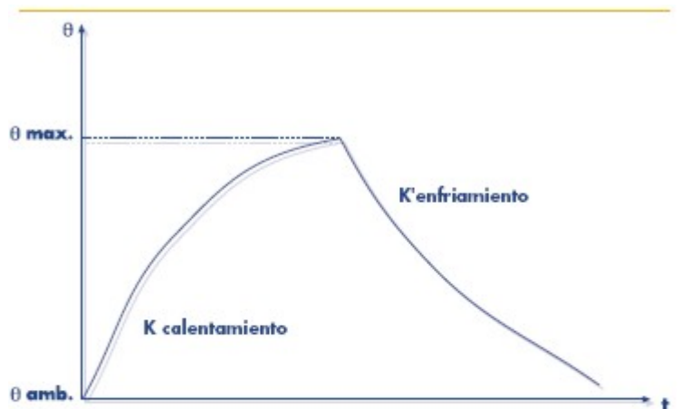
Figura 26: Característica relé de imagen térmica
