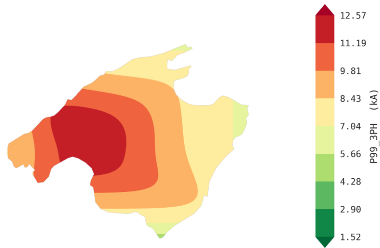
Figura 4. Mapa de curvas de nivel con la distribución de los valores máximos de intensidad de cortocircuito trifásico en los nudos de 220 kV.
