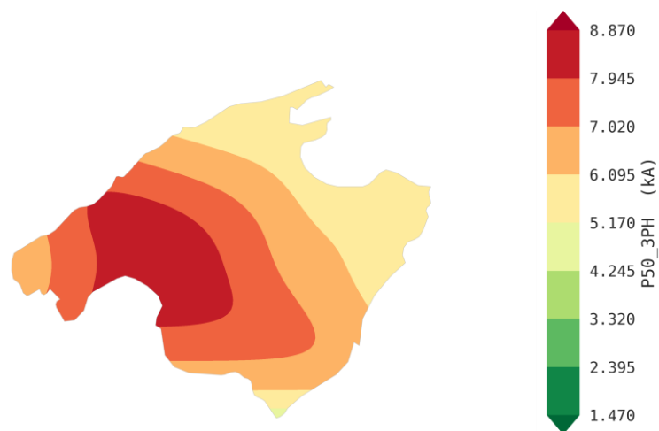
Figura 9. Mapa de curvas de nivel con la distribución de los valores medios de intensidad de cortocircuito trifásico en los nudos de 220 kV.
