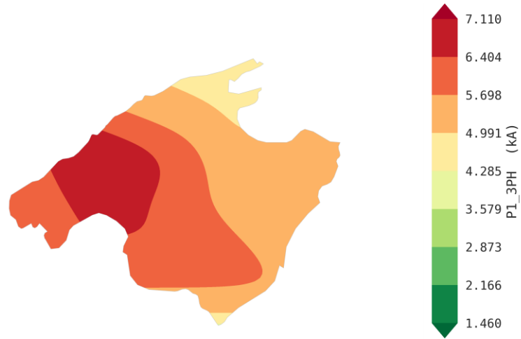
Figura 14. Mapa de curvas de nivel con la distribución de los valores mínimos de intensidad de cortocircuito trifásico en los nudos de 220 kV.
