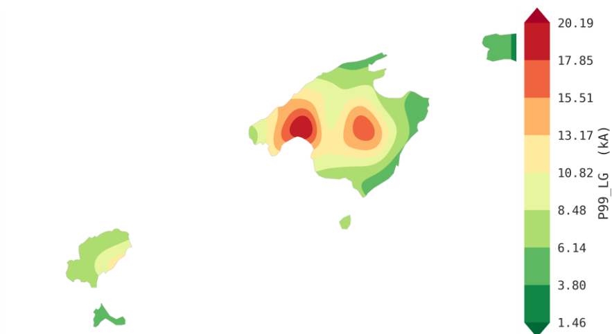
Figura 20. Mapa de curvas de nivel con la distribución de los valores máximos de intensidad de cortocircuito monofásico en los nudos de 66 kV.
